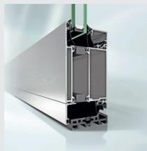
Fassade Schüco FWS 50: Pfosten-Riegel-Fassade mit 50 mm Ansichtsbreite, ermöglicht Fassadenkonstruktionen mit groß dimensionierten Glasflächen und ist auch als hochwärmedämmte Ausführung lieferbar.
