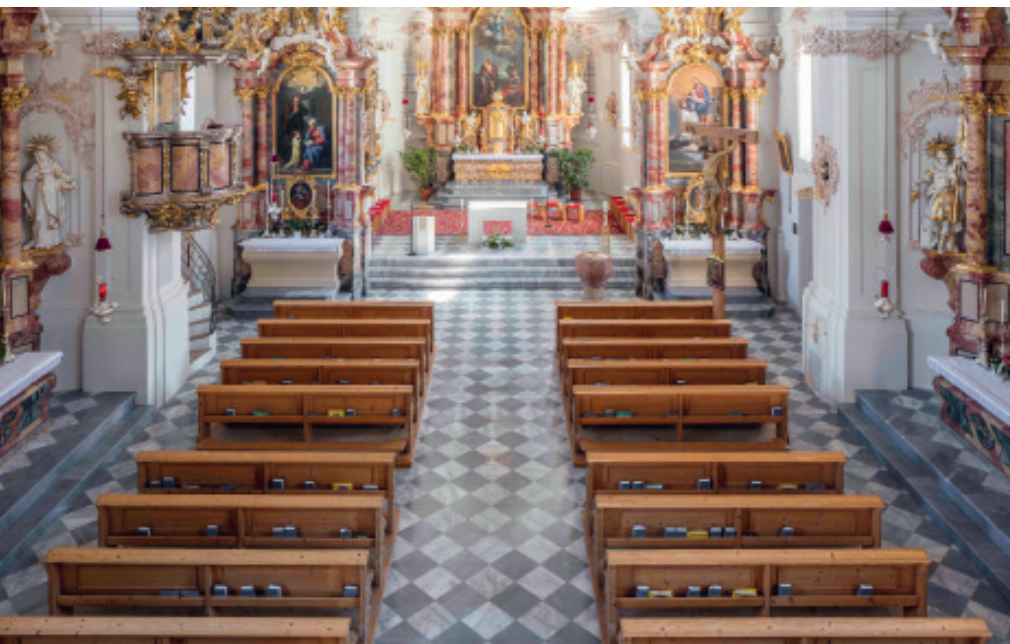
Der Bodenbelag und die Stufen der Pfarrkirche Axams sind mit hellen und dunklen Krastaler Marmorplatten ausgelegt.
